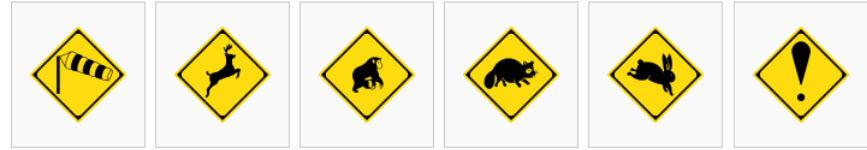
横風注意 (214) 動物が飛び出すおそれあり (214の2) 動物が飛び出すおそれあり (214の2) 動物が飛び出すおそれあり (214の2) 動物が飛び出すおそれあり (214の2) その他の危険 (215)
