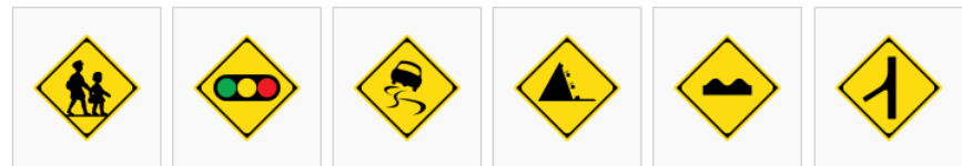
学校、幼稚園、保育所等あり (208) 信号機あり (208) すべりやすい (209) 落石のおそれあり (209の2) 路面凹凸あり (209の3) 合流交通あり (210)
