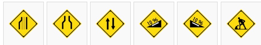
車線数減少 (211) 幅員減少 (212) 二方向交通 (212の2) 上り急勾配あり (212の3) 下り急勾配あり (212の4) 道路工事中 (213)
